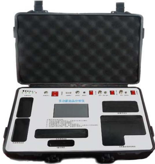
YPF 多功能油品质量分析仪主要由 ARM 高性能处理器、四合一油液传感器、水分传感器、4.3 寸电阻触摸 LCD、SD 卡接口和内置电源等组成。通过对在用润滑油取样，与所使用的新油进行对比，方便、快速、稳定的测量出润滑油的污染度，以及粘度、密度、温度、介电常数、含水量等参数。以低成本、简单的方法实现科学的按质换油，延长润滑油使用时间，及早发现设备故障，避免重大损失。
