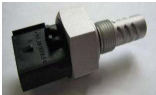
微水传感器是用来测量油液当中水含量的传感器。可直接测量油品的水含量和温度。水含量是模拟输出,典型输出范围为:1~4V,典型测量范围为:0~1000ppm。温度输出为电阻值,精度为 $\pm 1^{\circ}\text{C}$ ,最佳测量范围 $-30\sim 60^{\circ}\text{C}$ 。
