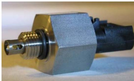
四合一传感器是创新的流体特性传感器,可直接和同时测量流体的粘度、密度、介电常数和温度。通过专利的音叉技术,传感器可以检测到诸如发动机润滑油、燃油、传动油、刹车液、液压油和齿轮油、冷冻液和溶剂等的流体的多个物理属性间的直接和动态的关系。
